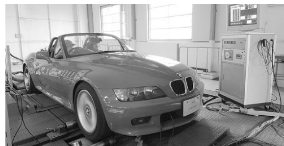
Thiết bị chạy thử nghiệm lái có thể đo vận tốc lên tới 200km (BMW)
